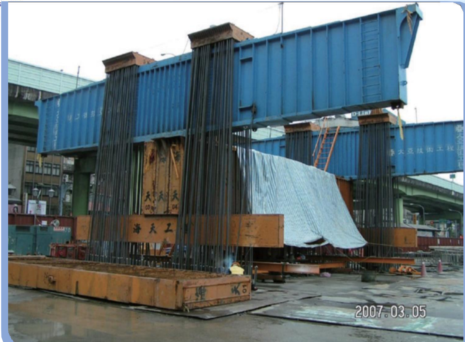
壁樁抗壓載重試驗
